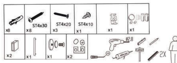
Alati i pribor: (libela; metar; ručna električna bušilica; set burgija za beton; odvrtići - ravni i zvezdasti; viljuškasti ključevi; čekić; olovka).
